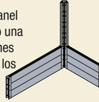
3. Se sigue Apilando los paneles a la altura deseada antes de agregar la segunda poste esquinero.
