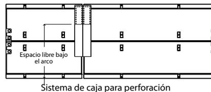
Se puede ajustar fácilmente a cajas para zanjas nuevas o existentes. Diseños a medida disponibles.
