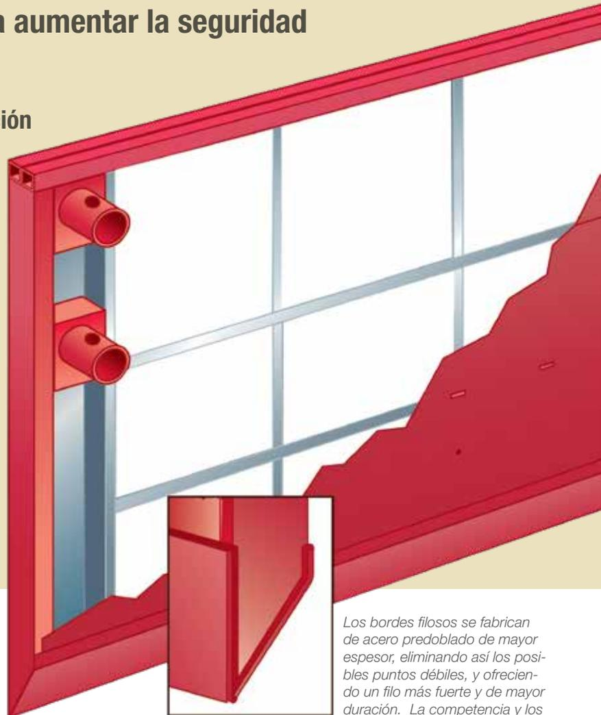
*Los bordes filosos se fabrican de acero predoblado de mayor espesor, eliminando así los posibles puntos débiles, y ofreciendo un filo más fuerte y de mayor duración. La competencia y los imitadores usan una extensión del revestimiento del panel lateral que es de menor calibre.*
