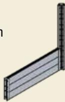
2. Coloque otro panel posterior, creando una "L". Instale los pines y los pasadores y los soportes.
