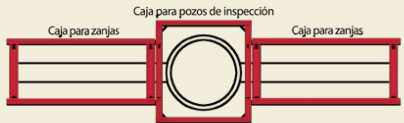
Vista superior de la construcción de una línea de tubería en la que se muestra cómo utilizar correctamente una caja para pozos de inspección con cajas para zanjas.
